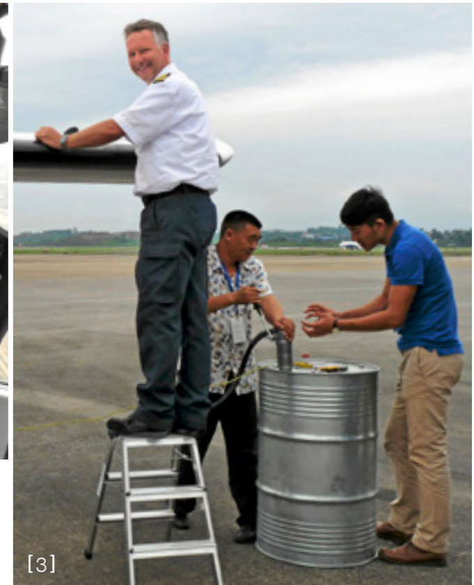
[1] Anflug auf den internationalen Flughafen von Nagpur in Indien. Beim ersten Ferryflug landet Markus Lürer hier in der Dunkelheit. [2] Unterwegs zwischen Muskat und Karachi wird es den PFDs zu heiß. Eine Selbstbau-Belüftung Marke „MacGuyver“ sorgt für Kühlung. [3] Betankung aus Fässern kann mühsam sein, weil an vielen asiatischen Plätzen mit Handpumpe gearbeitet werden muss. Zudem muss Markus Lürer aufpassen, dass nur sauberes Avgas in die Tragflächentanks der Observer fließt.
