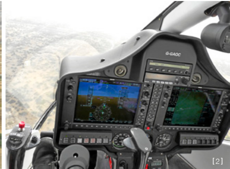
[1] Anflug auf den internationalen Flughafen von Nagpur in Indien. Beim ersten Ferryflug landet Markus Lürer hier in der Dunkelheit. [2] Unterwegs zwischen Muskat und Karachi wird es den PFDs zu heiß. Eine Selbstbau-Belüftung Marke „MacGuyver“ sorgt für Kühlung. [3] Betankung aus Fässern kann mühsam sein, weil an vielen asiatischen Plätzen mit Handpumpe gearbeitet werden muss. Zudem muss Markus Lürer aufpassen, dass nur sauberes Avgas in die Tragflächentanks der Observer fließt.
