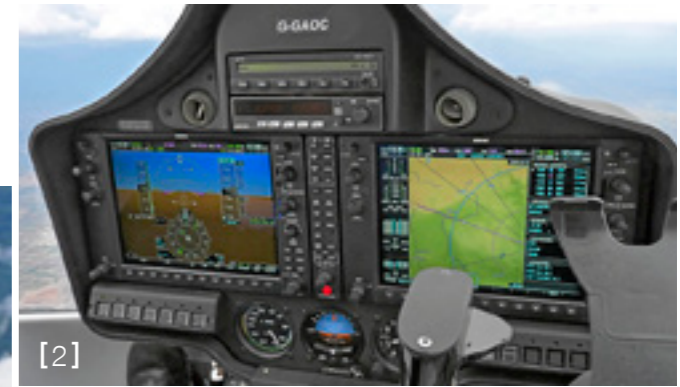
[1] Über dem Jangtsekiang (deutsch: langer Fluss). Mit 6380 Kilometern ist er der längste Fluss Asiens und der drittlängste weltweit. [2] Das Panel der P 68 Observer mit dem Garmin G950. Die beiden MFDs laufen unterwegs heiß, erholen sich aber relativ schnell wieder. [3] Der Copilotensitz bleibt bei Markus Lüers Überführungsflügen von Italien nach China leer. Stattdessen „parken“ hier Strecken- und Anflugkarten als Backup sowie Wasservorräte für die ziemlich langen Fluglegs.
